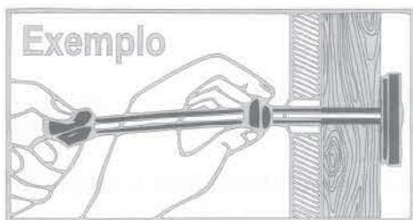
4º) Anclar el soporte del intercambiador utilizando el sujetador de anclaje (e) proporcionado de modo que el soporte del cambiador sea perpendicular a la cuna. Coloque el cambiador en la pared y coloque los tornillos (f) con la arandela metálica suministrada (H). Apriete los tornillos 04 con la llave suministrada (i). Quitar los anclajes.
